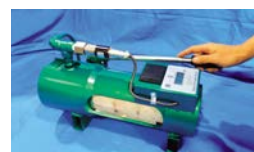
4. 供試体が割れるまで加圧し試験終了です。
