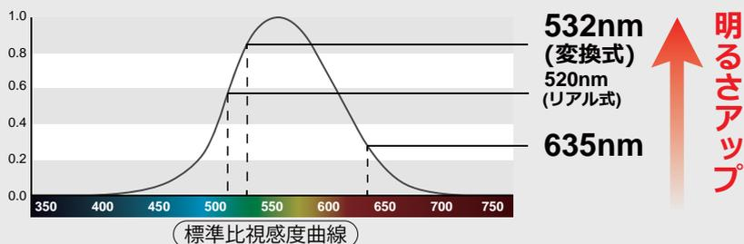
視感度曲線とは人の目が一番明るく感じる555nmを頂点とした曲線で、変換式レーザーは流通している製品の中で最も高い視感度を持っています。
